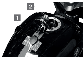
Fig. 10 1. Llave de encendido 2. Seguro de combustible
