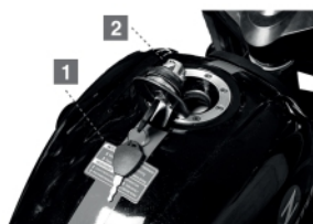
Fig. 10 1. Llave de encendido 2. Seguro de combustible
